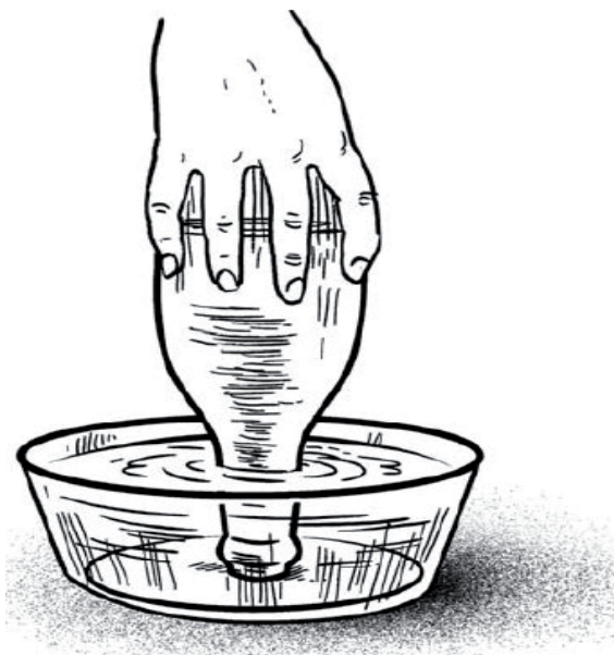
Зарфи ҳаводори ба об чаппа ғўтонидашуда
